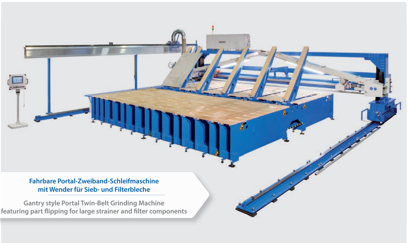
Maschinen-Laufwerk mit 4-Rad-Antrieb Movable gantry with 4-wheel-drive
